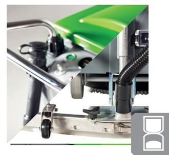
Griff und Saugfuß sind serienmäßig aus rostfreiem Edelstahl WNR. 1.4301 gefertigt. Das sichert einen unproblematischen Einsatz auch bei der Verwendung von hochaggressiven Reiniger
