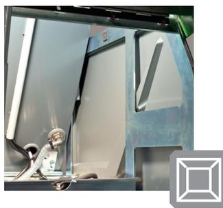
Das Gestell ist voll verzinkt und bietet so den besten Korrosionsschutz für die Schweißkonstruktionen aus Stahl
