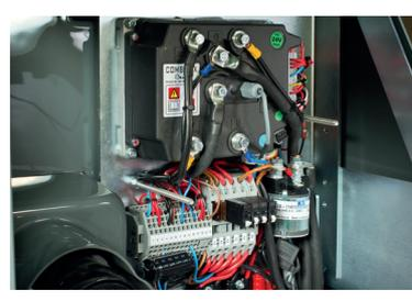
Die **ACX-Steuerung** ermöglicht die Vernetzung verschiedener Funktionen und steuert so optimal Betriebszustände wie z. B. den Sanftanlauf von Bürsten- und Saugmotoren, die GWS-Steuerung sowie programmierbare Parameter wie Bremsverhalten oder Geschwindigkeit
