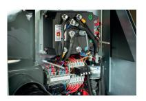
Die ACX-Steuerung ermöglicht die Vernetzung verschiedener Funktionen und steuert so optimal Betriebszustände wie z.B. den Sanftanlauf von Bürsten- und Saugmotoren, die GWS-Steuerung sowie programmierbare Parameter wie Bremsverhalten oder Geschwindigkeit
