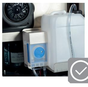
GWS Chemplus optional erhältlich. An der Dosierpumpe kann das Mischungsverhältnis im 10er Raster von 1:5000 bis 1:50 (0,2-2 %) eingestellt werden.
