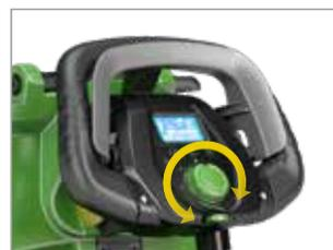
VOLLSTÄNDIGE KONTROLLE ÜBER DIE MASCHINE DANK EINEM INTUITIVEN ZENTRALEN BEDIENKNOPF.
