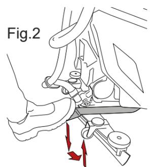
Desenganche automático del cepillo, versión con pedal de levantamiento del cabezal: levante el cabezal de la máquina empujando hacia abajo y hacia la izquierda el pedal de levantamiento del cabezal (Fig. 1), gire el selector hacia la posición "OFF", pulse una vez el botón "SET" y luego pulse el botón "-", la máquina ejecutará la secuencia de desenganche.
