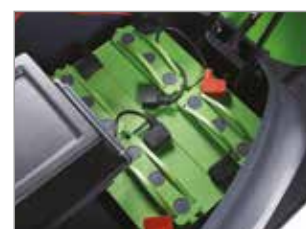
ALOJAMIENTO DE BATERÍAS (PARA 1050 E)
