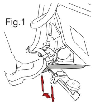
Sgancio automatico spazzola, versione con pedale di sollevamento testata: alzare la testata della macchina spingendo in basso e quindi a sinistra il pedale sollevamento testata (Fig.1), ruotare il selettore nella posizione "OFF", premere una volta il pulsante "SET" quindi premere il pulsante "-", la macchina eseguirà la sequenza di sgancio.
