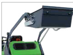
SISTEMA HIDRÁULICO DE DESCARGA DEL DEPÓSITO
